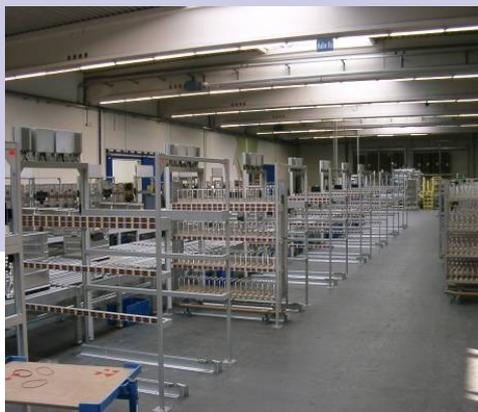
Anstelle mehrere hundert Kommissionierwagen einzeln mit Pick by Light auszurüsten, wurden lediglich 66 stationäre Sortiergestelle speziell angefertigt und mit Anzeigemodulen bestückt. Hiermit konnte Weltbild erheblich die Investitionskosten senken.
