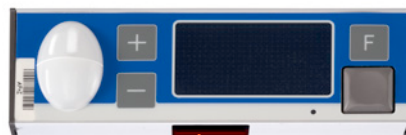
Mit QRS-DOWN (Bewegungs-Sensor für die berührungslose Quittierung)
