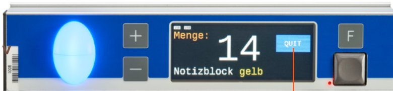
Resistiver Touchscreen mit frei definierbare Softkeys (On-Screen-Tasten)
