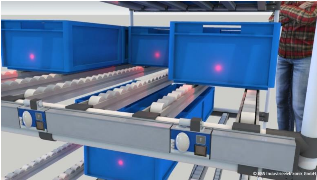
Bild 1: Füllstanderkennung mit TOF-Modul und Put-to-Light Fachanzeigen an der Befüllseite eines DLR [Schematische Visualisierung. Tatsächlich handelt es sich um einen nicht sichtbaren Laserstrahl der Laserklasse 1, der auch ohne Schutzvorkehrungen für das menschliche Auge sicher ist.]
