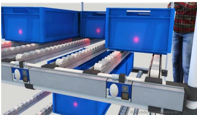
Füllstandserfassung mit TOF-Modul und Put-to-Light Fachanzeigen an der Befüllseite eines Durchlaufregals [schematische Darstellung]
