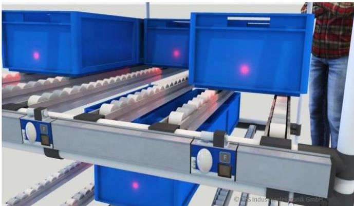
saisie de niveaux de remplissage avec un module TOF et des afficheurs Put-to-Light sur le côté remplissage d'un rayonnage dynamique. [visualisation schématique]
