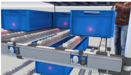
Füllstandserfassung mit TOF-Modul und Put-to-Light-Fachanzeigen an der Befüllseite eines Durchlaufregals (schematische Visualisierung).
