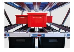
Der Behälter-Füllstand wird durch einen leistungsstarken Distanz-Sensor kontinuierlich berührungslos überwacht. Sobald sich nur noch eine definierbare Mindest-Anzahl an Behältern im Regal befindet, meldet dies der Sensor an die Nachschubsteuerung des überlagerten Systems.
