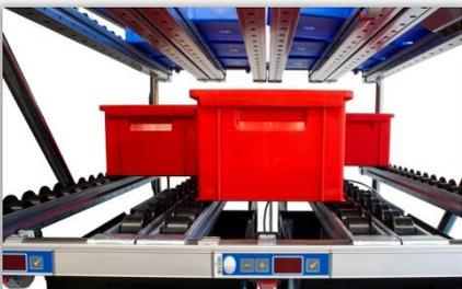
Füllstand-erfassung mit E-Kanban-Modul und Put-to-Light-Fachanzeigen an der Befüllseite eines Durchlaufregals.
